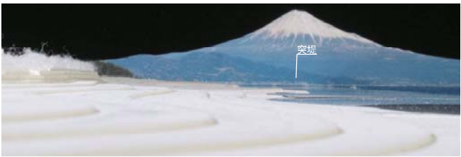
模型 L型突堤 20 年后的预测
