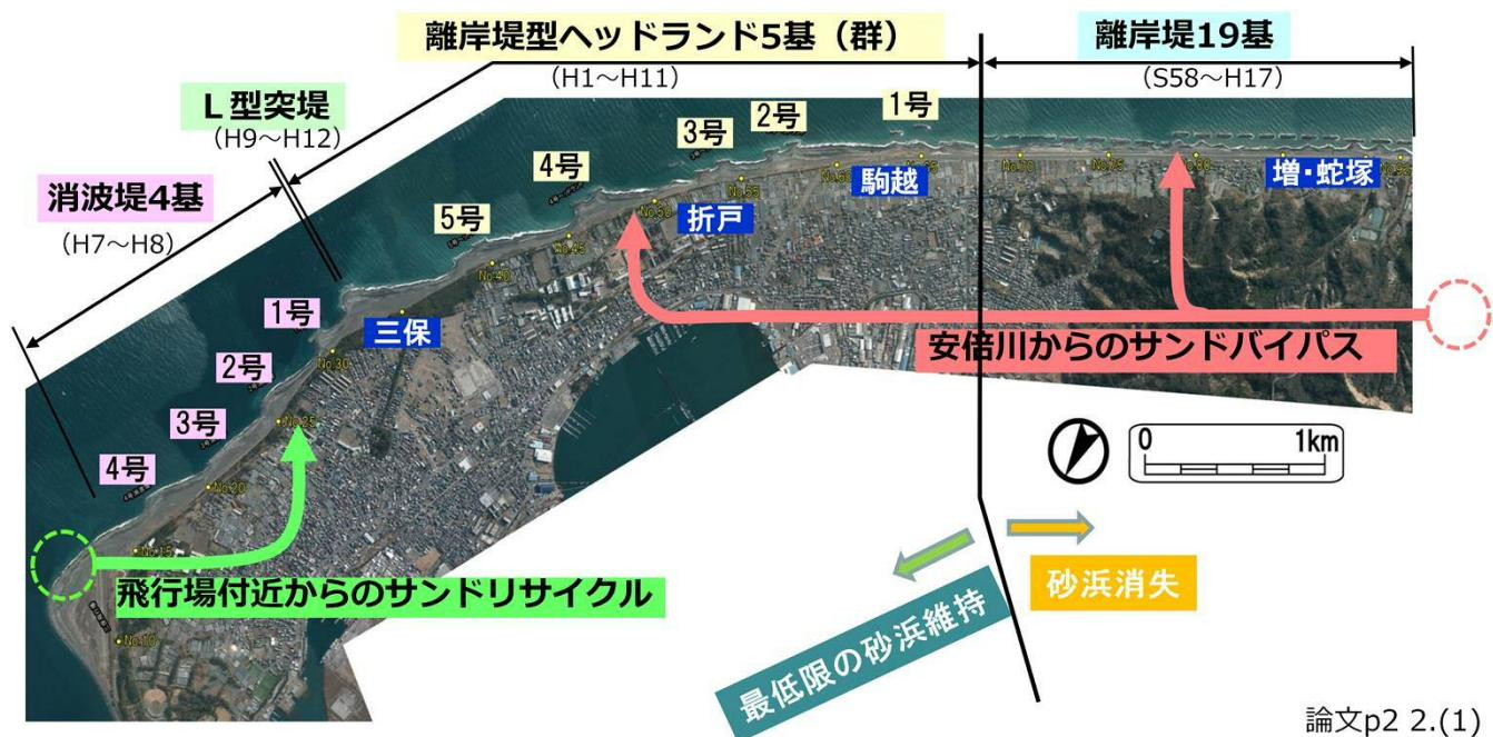
1989年（平成元年）の時点で既に砂浜が侵食を受けて消失していた増・蛇塚地区では、離岸堤を設置。
