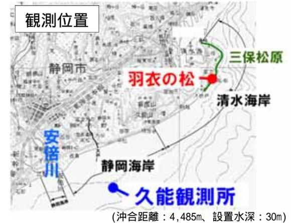
【清水海岸の計画外力(50年確率波)】: 沖波波高 $H_o=12.0m$ 、周期 $T_o=17.0s$  (石廊崎測候所の観測データ(1976年から22年間)による)
