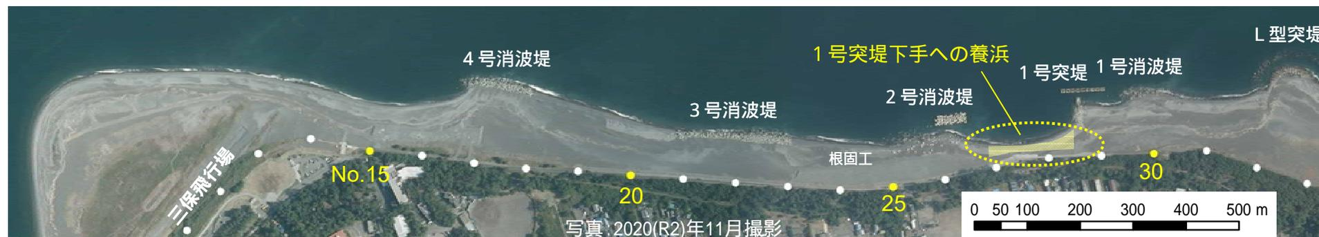
令和2年度の養浜は1号突堤下手区間に集中的に実施するため、必要浜幅を満足する上手側への養浜は未実施（上手側への養浜が必要な際は以下の断面とする）
