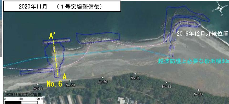
空中写真による1号突堤周辺の汀線形状の変化
