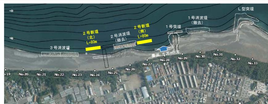
2次選定【ケース5：2号新堤（南）＋根固工＋養浜区域拡大】
