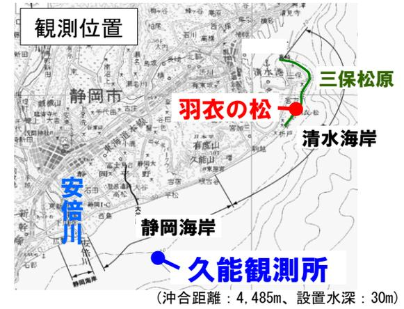
【清水海岸の計画外力(50年確率波)】：沖波波高 $H_0=12.0m$ 、周期 $T_0=17.0s$ （石廊崎測候所の観測データ(1976年から22年間)による）
