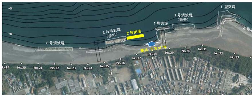
【**下手案**】ケース9：2号消波堤の下手側に2号突堤+養浜
