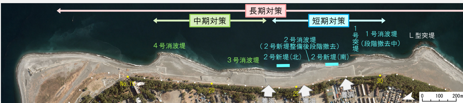
景観に配慮した最小限の施設と養浜の組み合わせにより、防護機能の確保と景観の両立を図ります
