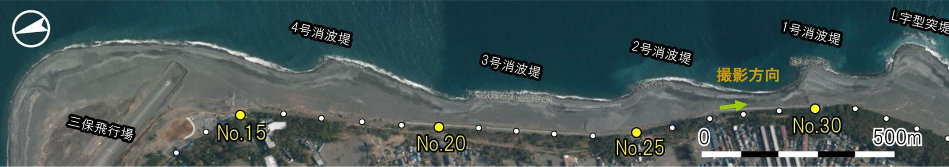
・台風18号の高波浪により、堤防基礎露出範囲が80mから117mに拡大
