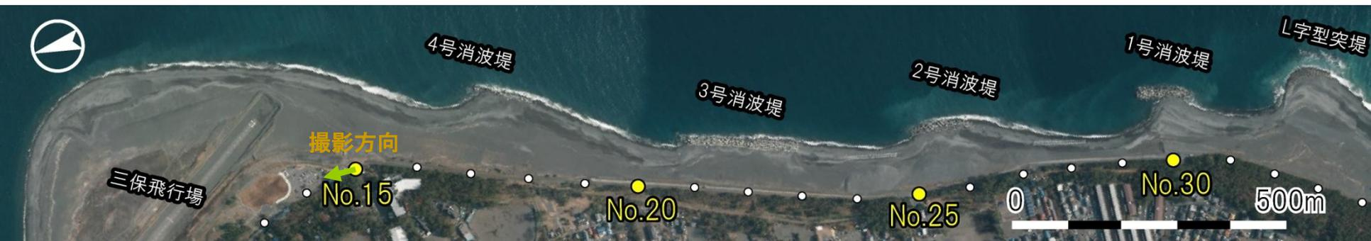
・堤防前面まで波浪が遡上したが、堤防嵩上げにより越波被害は生じていない
