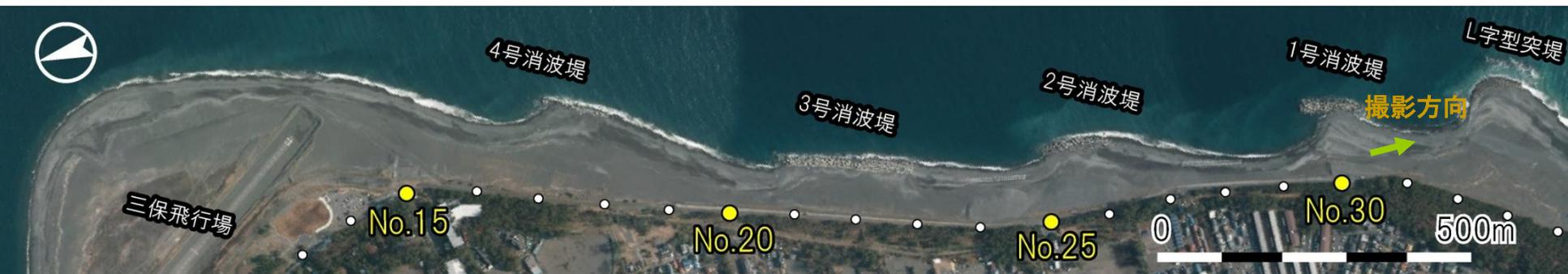
・ L字突堤上手側に遡上した波が縦堤を越えて下手側に通過（上手側の土砂が下手側に移動）
