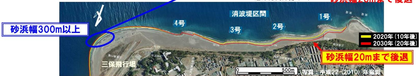
・現状を放置した場合は、L字突堤下手、1号～3号消波堤下手で大きく必要砂浜幅を割り込む（1号下手で砂浜幅20m）ため、堤防決壊や背後地への越波被害が懸念される
