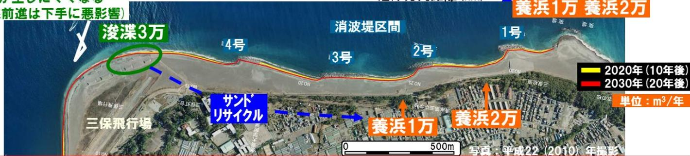
・ 区間全体で概ね現状汀線を維持し、必要砂浜幅80mが確保できるが、L字突堤下手・1号下手で必要砂浜幅が不足
