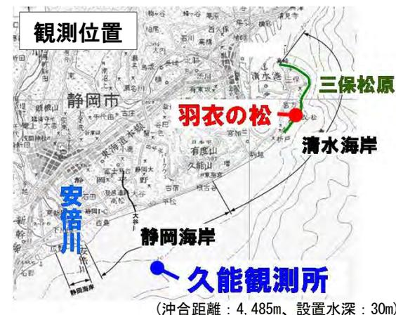
【清水海岸の計画外力(50年確率波)】: 沖波波高 $H_0=12.0m$ 、沖波周期 $T_0=17.0s$ (石廊崎測候所の観測データ(1976年から22年間)による)
