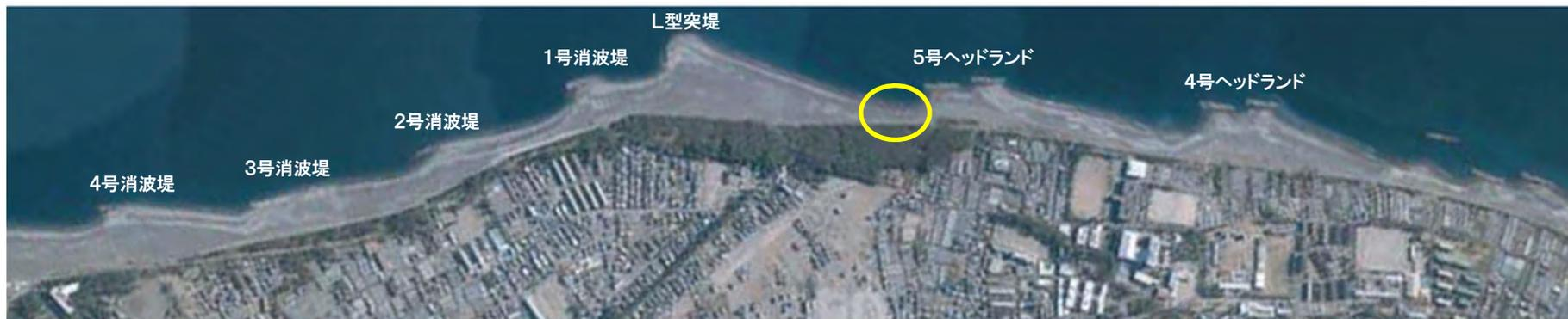
○緊急対応として、ヘッドランドや消波堤の背後に残存した養浜材の押土を実施（平成27年9月上旬完了）
