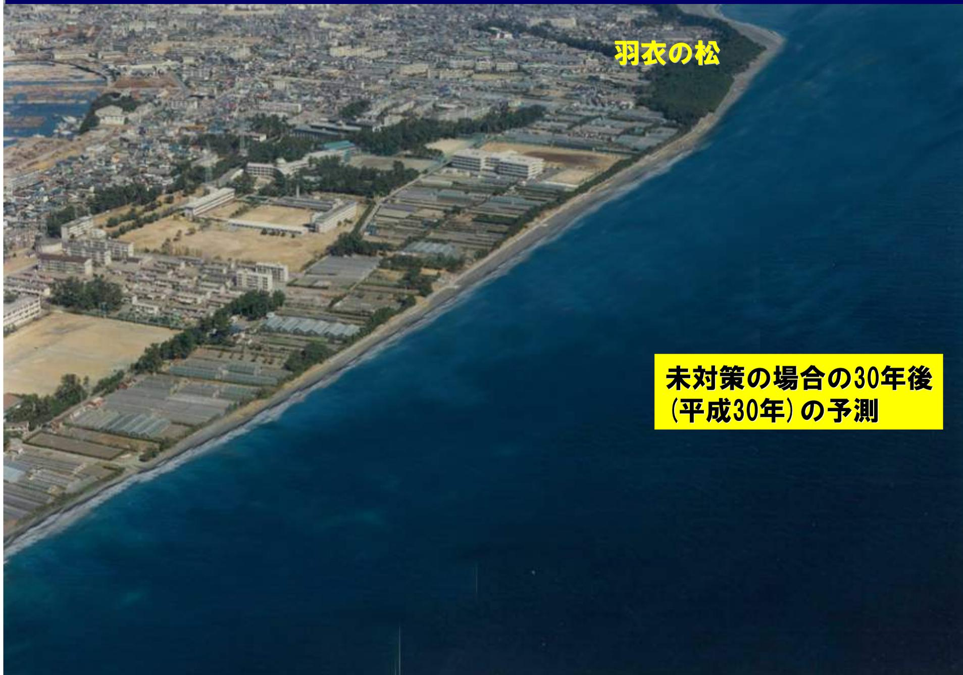
静岡海岸と清水海岸の一部（増・蛇塚地区）では、砂浜消失により頻発するようになった越波被害を軽減するため、離岸堤や消波工を連続的に整備
