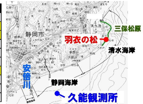
【清水海岸の計画外力 (50年確率波)】: 沖波波高 $H_o=12.0m$ 、沖波周期 $T_o=17.0s$  (石廊崎測候所の観測データ (1976年から22年間) による)
