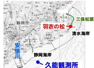
【清水海岸の計画外力(50年確率波)】: 沖波波高  $H_0=12.0m$ 、沖波周期  $T_0=17.0s$  (石廊崎測候所の観測データ(1976年から22年間)による)
