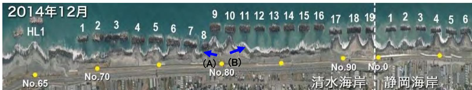
離岸堤背後の水域が狭く、汀線際の沿岸漂砂は動きにくい。また、離岸距離が小さく、背後は堆砂しやすい。
