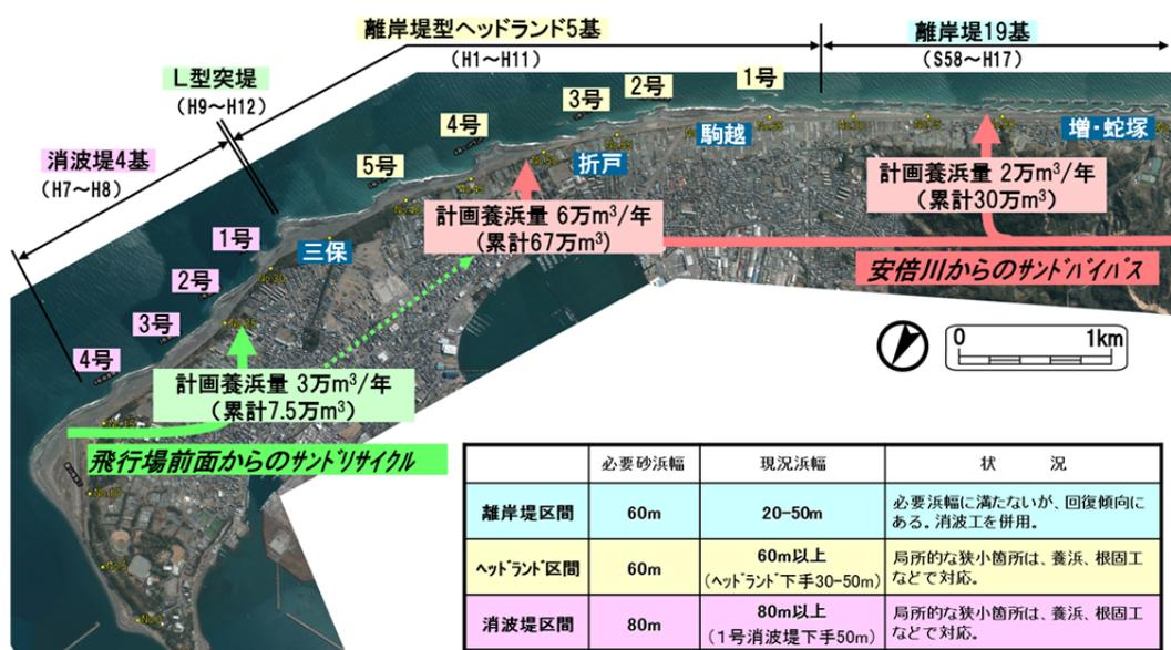
図-2.2 清水海岸の海岸保全施設配置と必要砂浜幅
