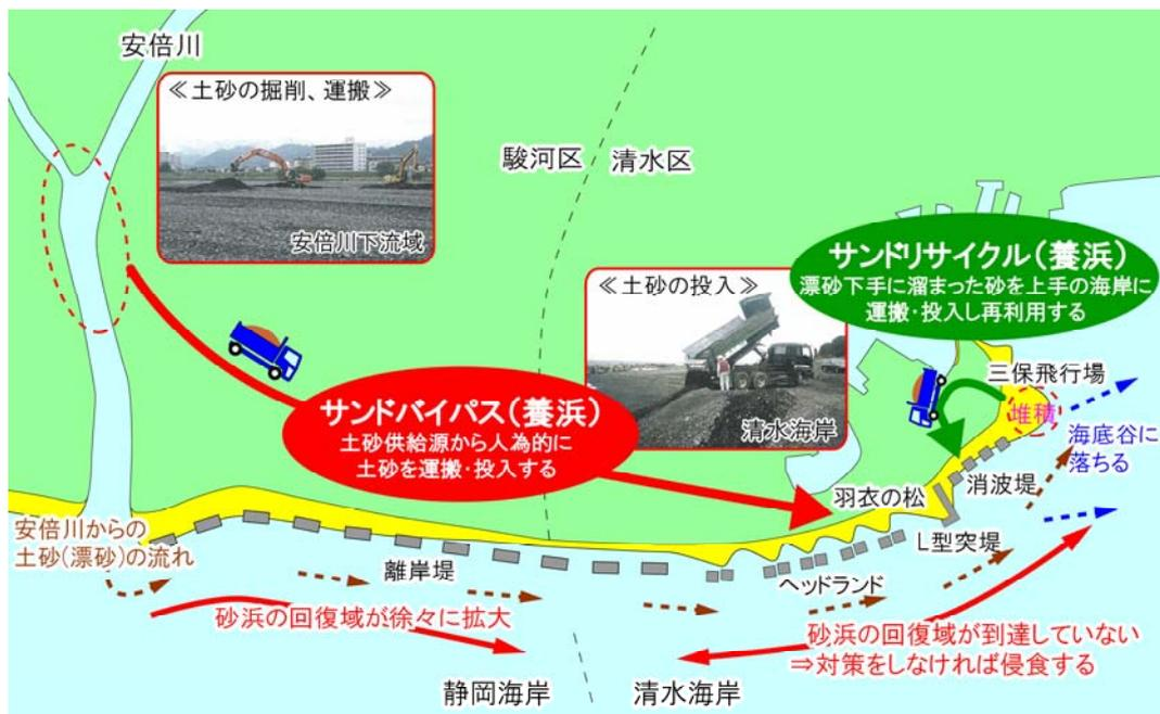
図-2.3 サンドバイパス養浜とサンドリサイクル養浜
