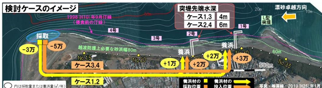
図-4.1 海浜変形シミュレーション（詳細検討）の検討ケース
