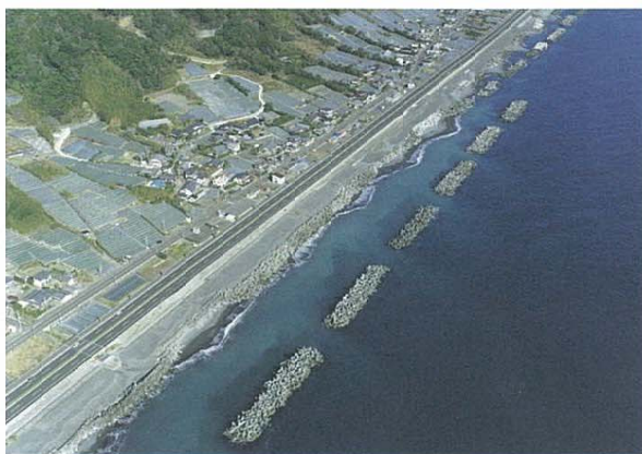
③ 離岸堤に砂がまだ到達していない(清水海岸増地区)
